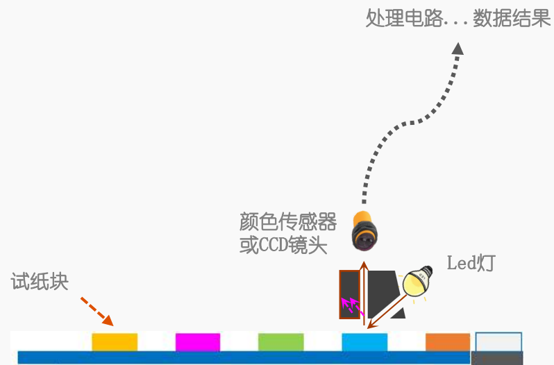
图3 全波长光电或颜色传感核心光学结构
